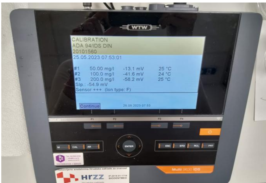
Slika 6. Kalibracija fluor-selektivne elektrode.
