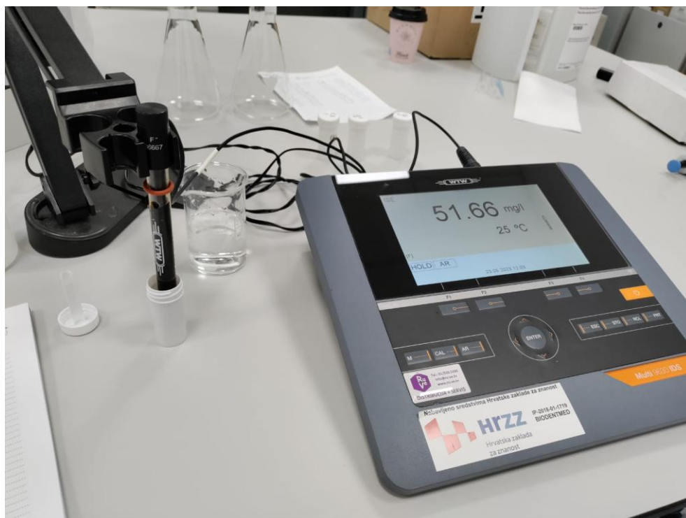
Slika 9. Mjerenje koncentracije otpuštenih fluoridnih iona fluor-selektivnom elektrodom.
