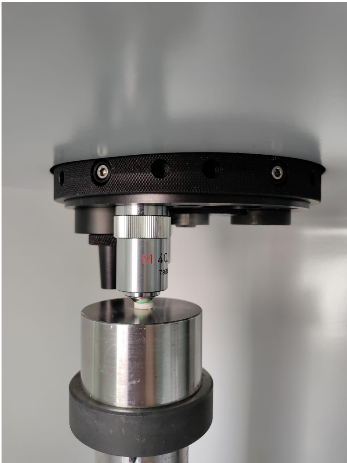
Slika 16. Mjerenje mikrotvrdoće na uzorku.
