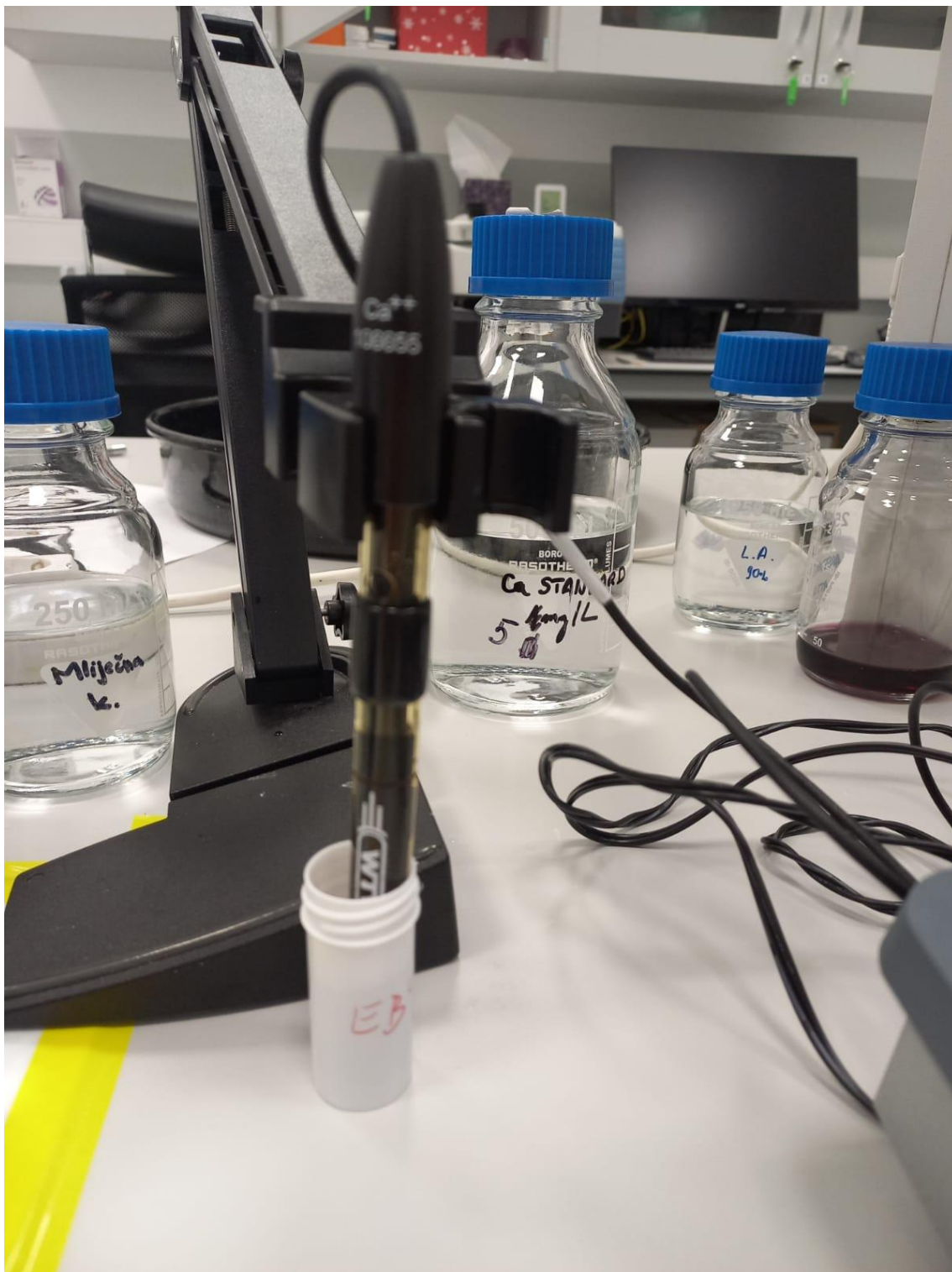
Slika 13. Mjerenje koncentracije otpuštenih iona kalcij-selektivnom elektrodom.
