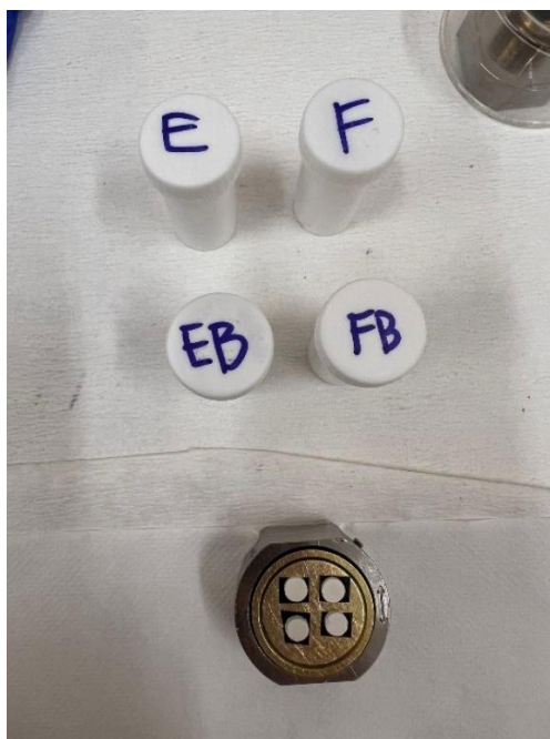
Slika 17. Uzorci pripremljeni za SEM-EDS analizu.
